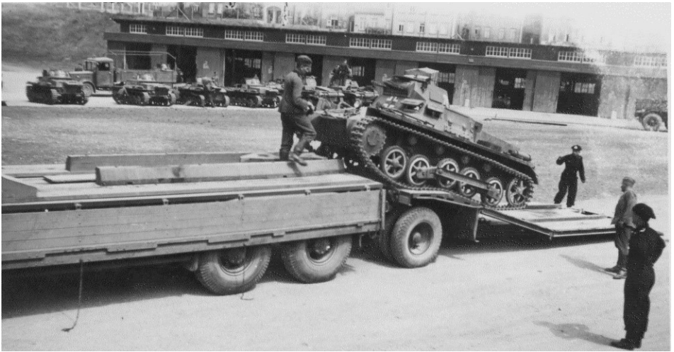
Verladen eines Panzer I auf den Kompanie eigenen LKW 12to in Eisenach
